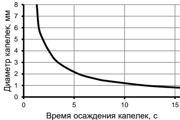
Рисунок 1 – Зависимость диаметра капелек от длины зоны сепарации
