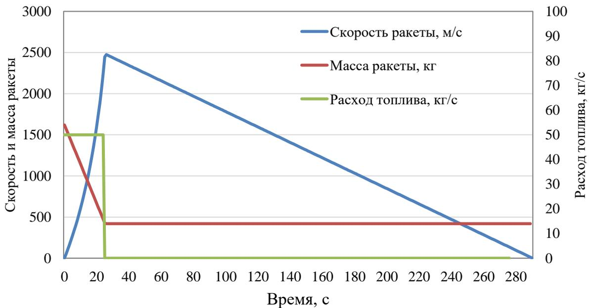
Рисунок 1 - Графики изменения скорости и массы ракеты, расхода топлива за период управления
