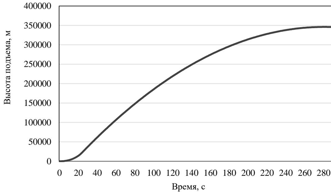
Рисунок 2 - График изменения высоты подъема ракеты за период управления
