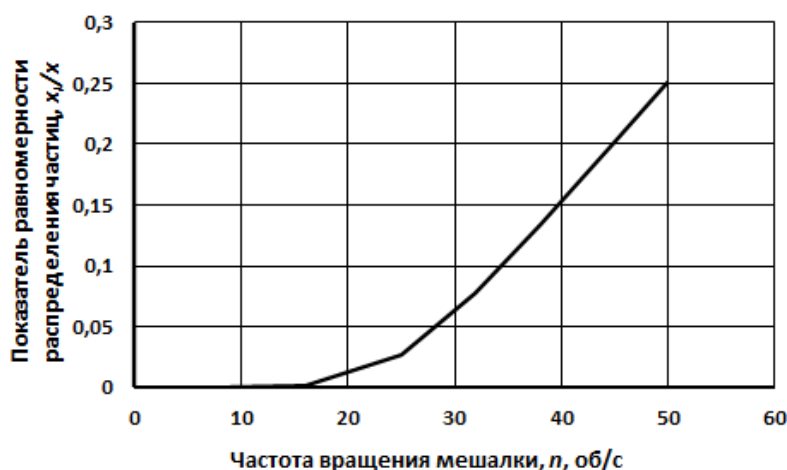
Рисунок 3 – Зависимость показателя равномерности распределения частиц x_l/x от частоты вращения мешалки.
