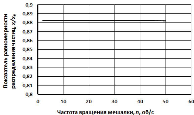
Рисунок 4 – Зависимость показателя равномерности распределения частиц x/x_R от частоты вращения мешалки.
