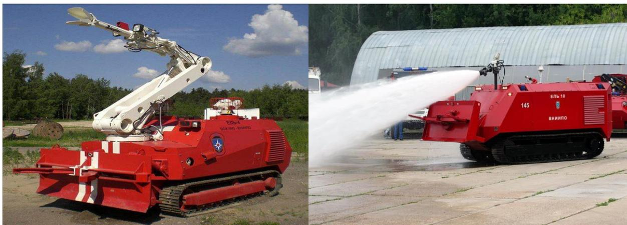
Рисунок 2 - Противопожарный робототехнический комплекс Ель-4 и Ель-10
