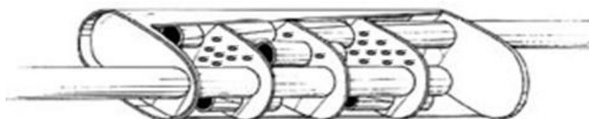
Рисунок 2 - Принципиальное устройство глушителя типа «акустическое зеркало» [7]
