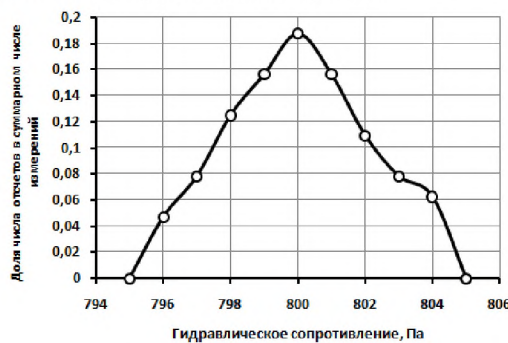
Рис. 4. Кривая распределения измеренных значений гидравлического сопротивления.
