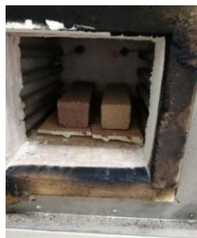
Рисунок 2 – Муфельная печь с образцами
