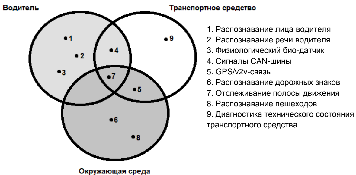
Рисунок 1 – Активная безопасность транспортного средства с учетом взаимодействий элементов системы ВАДС
