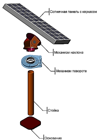
Рисунок 4 – Элементная схема солнечного трекера
