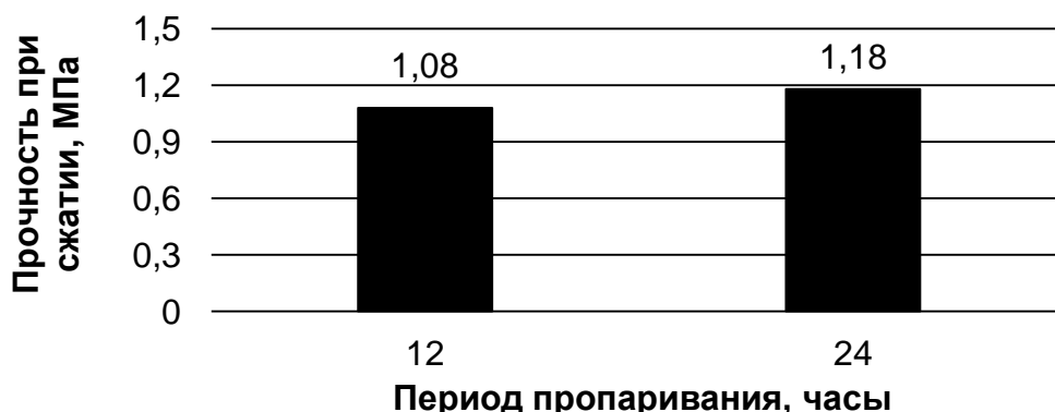
Рисунок 2 – Прочность при сжатии неавтоклавного пенобетона марки D600 на синтетическом пенообразователе в зависимости от времени пропаривания.
