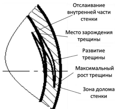
Рисунок 3 – Поперечное сечение зоны разрушения стенки
