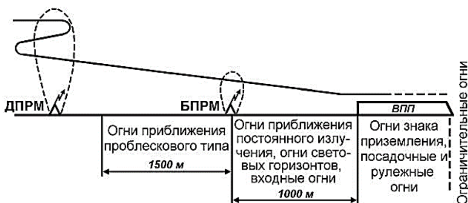
Рисунок 2 – Схема расположения огней в зоне воздушных подходов ВС к ВПП
