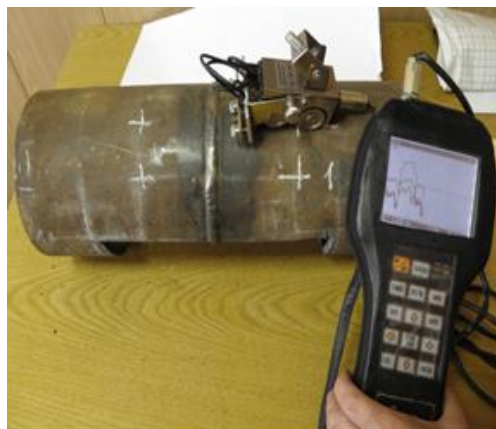
Рисунок 2 - Индикатор трещин ИКН -2М-8 с датчиком
