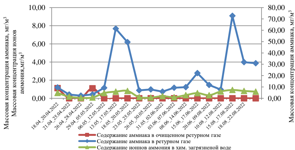
Рисунок 1 – Содержание аммиака в газе ретурном до и после отмывки и ионов аммония в отработанной промышленной воде
