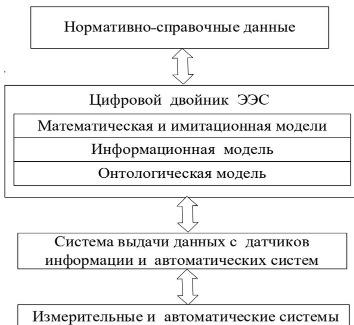
Рисунок 1 - Структурная схема управления и контроля ЭЭС при использовании цифрового двойника
