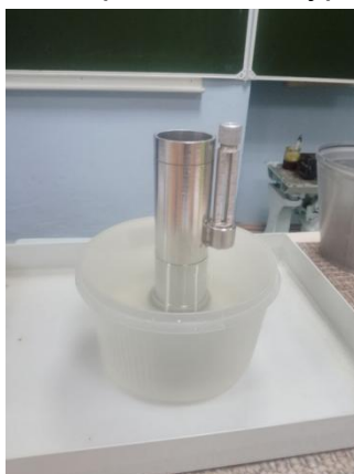
Рисунок 1 – Определение коэффициента фильтрации при переменном градиенте напора трубкой Каменского
