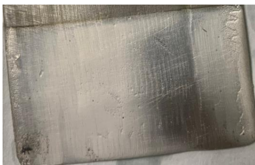
Рисунок 2 – Никелевое покрытие в ячейке Хулла при концентрации 1-хлорметилсилатрана 0,03 г/л и силе тока 1 А.
