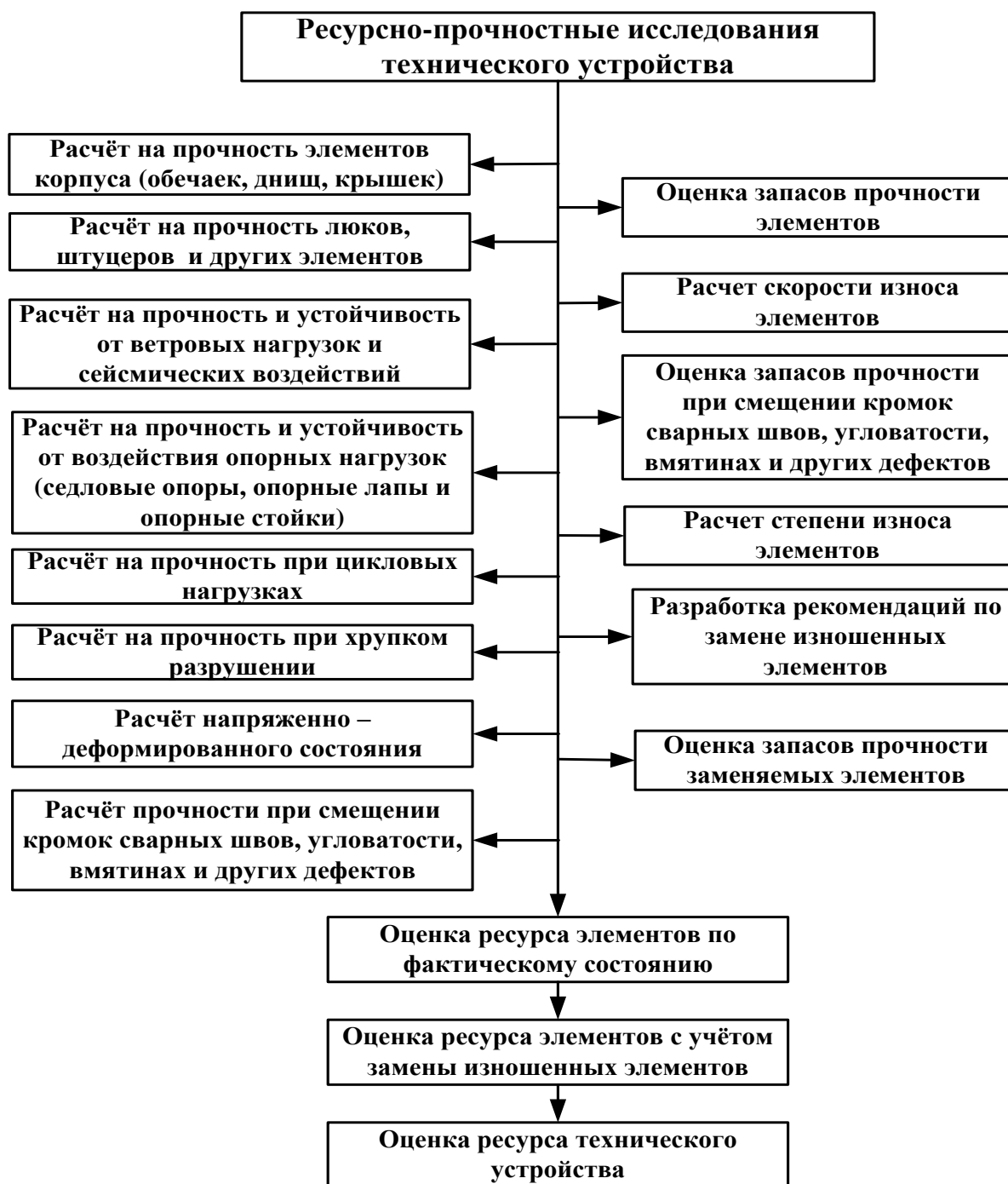
Рисунок 2 - Схема проведения ресурсно-прочностных исследований сосудов
