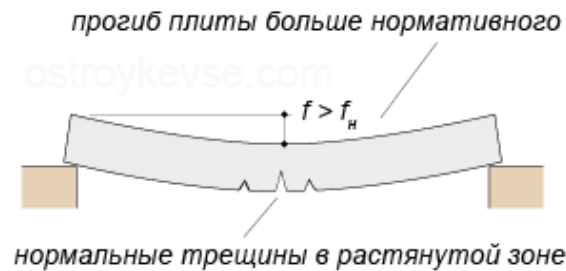
Рисунок 1 – Возможные повреждения в растянутой зоне бетона
