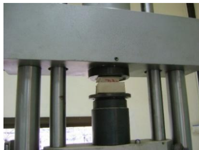
Рисунок 2 – Испытание образцов на сжатие
