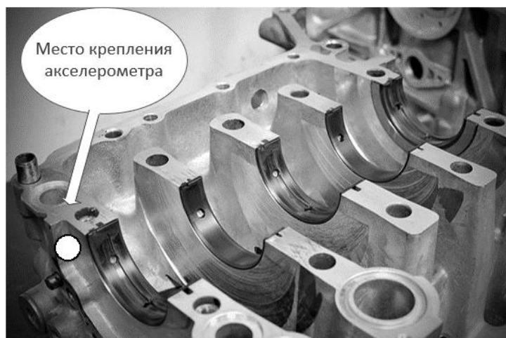
Рисунок 2 – Место крепления акселерометра вблизи коренного подшипника
