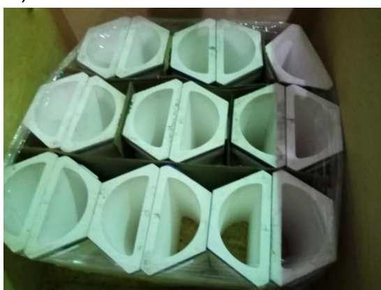
Рисунок 2 – Фото изделий, изготовленных из огнеупорных бетонов при помощи 3D-принтера: а), б) – дробители (разделители) потоков (оптимизация скорости потока); в), г) – направляющие для закручивания (завихрения) потока
