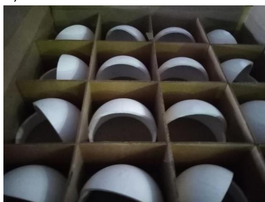
Рисунок 2 – Фото изделий, изготовленных из огнеупорных бетонов при помощи 3D-принтера: а), б) – дробители (разделители) потоков (оптимизация скорости потока); в), г) – направляющие для закручивания (завихрения) потока
